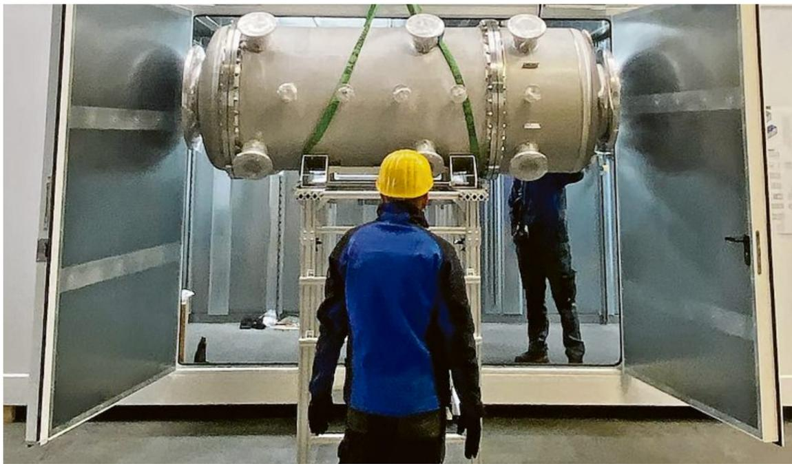
Eine Plasmalyse-Anlage. Durch die Plasmalyse wird Wasserstoff aus Kohlenstoff- und Stickstoff-Verbindungen wie etwa Methan oder Gülle gewonnen.
