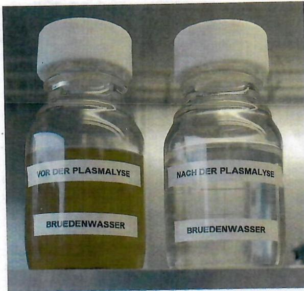
Brüdenwasser, das bei der Trocknung von Klärschlamm anfällt, vor und nach der Plasmalyse. Verfahrensbedingt ist bei dieser Technologie die Gewinnung von Wasserstoff mit einer Reinigung des als Elektrolyt eingesetzten Schmutzwassers verbunden.
