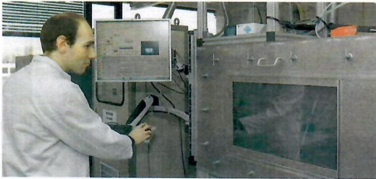
Dr. Simon Schneider überwacht am Plasmalyzer im Entwicklungslabor von Graforce den Prozessablauf der Dissoziation von schadstoffbelastetem Brüdenwasser zur Gewinnung von Wasserstoff.
