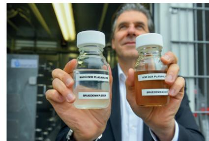
Bild 2 Brüdenwasser aus der Klärschlamm-trocknung vor und nach der Plasmalyse
